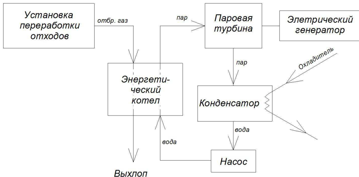
Рис.1. Принципиальная схема комплексной энергоустановки
